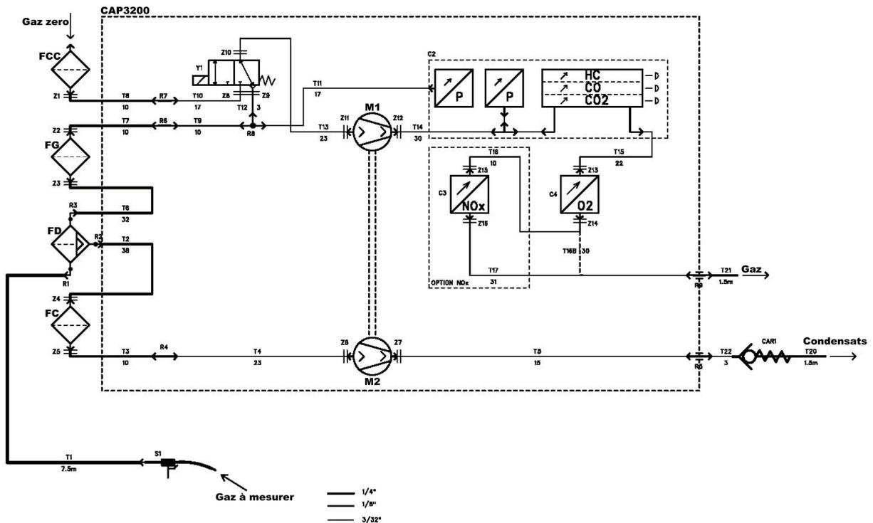
L'entrée des gaz à mesurer se situe sur le filtre décanteur FD après que ceux-ci aient été aspirés au travers de la sonde de prélèvement.
